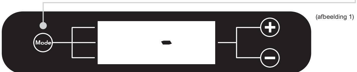
Zodra het apparaat ingeschakeld wordt, zal de display de aanbevolen temperatuur voor het koelgedeelte weergeven (+5°C). Voor wat betreft het vriescompartiment zal het apparaat automatisch naar de aanbevolen temperatuur van -18°C gaan.
