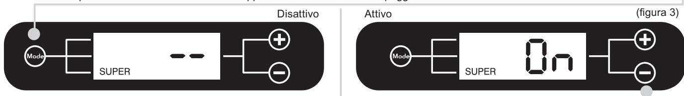
Premere il tasto (+) per attivare la funzione SUPER. Trascorse 8 ore disporre i cibi da congelare nel vano freezer. Trascorse altre 26 ore il prodotto uscirà automaticamente dalla funzione SUPER, nel caso si voglia interrompere la funzione SUPER prima dello scadere delle 8 + 26 ore premere il tasto (-).
