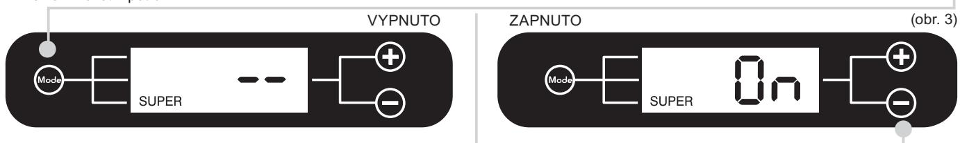
Funkce SUPER se zapíná stisknutím tlačítka (+). Po 36 hodinách spotřebič funkci SUPER automaticky vypne. Pokud byste chtěli funkci SUPER vypnout dřív, stiskněte tlačítko (-). Pro optimální používání výrobce doporučuje, abyste funkci super mražení zapnuli několik hodin před vložením vybraných potravin do mrazničky. Typový štítek stanovuje maximální množství potravin, které mohou být zmrazeny (viz obrázek 6).
