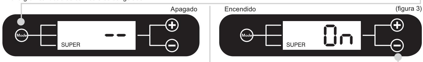
Pulse el botón (+) para poder activar la función SUPER. Al cabo de 36 horas, el producto abandonará automáticamente la función SUPER. Si desea interrumpir la función SUPER en cualquier momento, pulse el botón (-). Para un uso óptimo, el fabricante aconseja que la función de súper congelación esté activada durante varias horas antes de colocar los alimentos seleccionados en el congelador. La placa indicadora muestra la cantidad máxima de comida que puede ser congelada.
