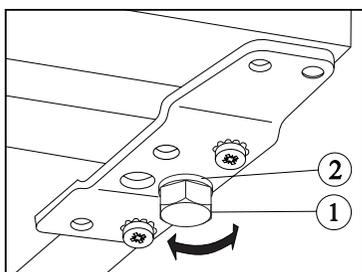
Het apparaat moet waterpas staan. Daartoe kunt u de stelvoeten (1) aan de voorzijde verstellen. De afstandsringen (2) zijn onderdeel van de stelvoeten. Als het apparaat waterpas moet worden gezet, kunnen deze afstandsringen worden verwijderd.
