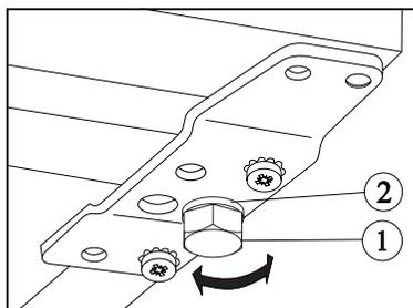
A la pose de l'appareil veillez à ce que sa position soit horizontale. Réglez cette position à l'aide des deux pieds réglables sur la partie inférieure avant
