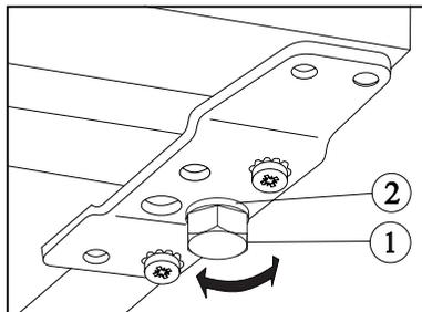
Når apparatet stilles på plads, skal man sikre, at det står plant. Det opnår man med to justerbare fødder (1) i bunden foran. Afstandsskiverne (2) er tilbehør til de justerbare fødder. Hvis det er nødvendigt at ændre apparatets højde, kan man fjerne disse skiver.
