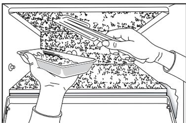
Hvis rim- eller islaget bliver så tykt, at det ikke kan fjernes med skraberen, er en regulær afisning nødvendig. Hvor tit det er nødvendigt afhænger af, hvor meget fryseren bliver brugt.
