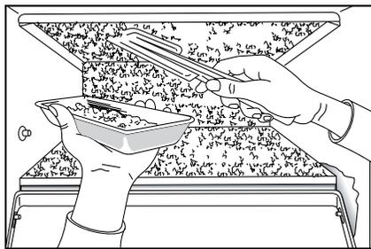
Si peu de givre ou de glace s'est formé, il est possible de gratter ou éliminer la couche de givre ou de glace en utilisant le grattoir livré avec l'appareil.
