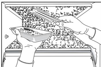
Bij geringe dauw- en ijsvorming is het wegkrabben resp. verwijderen van de ontstane dauw- en ijslaag mogelijk met de bij het apparaat geleverde krabber.
