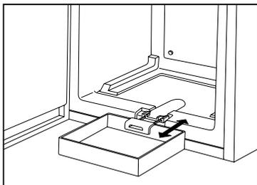
Træk forsigtigt det afløb, der sidder i midten forenden på fryseren, i pilens retning. Gennem denne åbning løber tøvandet ned i skålen.
