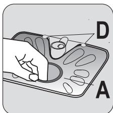
**5** Réinstallez le filtre plat A au fond de l'appareil. Veillez à ce qu'il soit bien installé sous les deux rails D.
