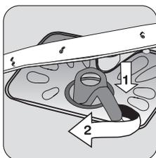
**6** Installez le système de filtre. Pour verrouiller le système de filtre, tournez la poignée dans le sens des aiguilles d'une montre jusqu'à ce qu'elle se verrouille.
