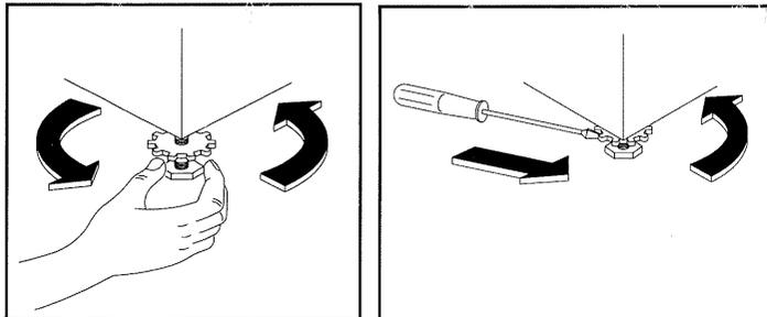
Mettez l'appareil à niveau en vissant ou en dévissant les vérins.
