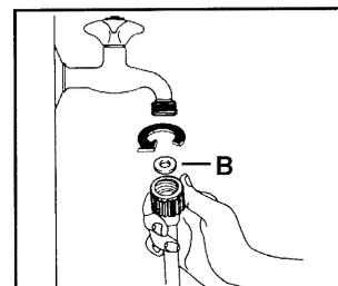
Vissez le raccord du tuyau d'alimentation sur le nez fileté du robinet d'arrivée d'eau (20x27), en ayant soin de bien positionner le joint **B** prévu dans le sachet livré avec l'appareil.
