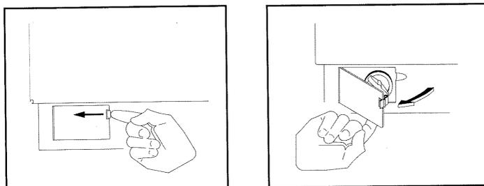
Placez dessous un récipient de faible hauteur à bord droit. Selon les modèles, complétez éventuellement la vidange de l'appareil en retirant le bouchon jaune et en extrayant le petit tuyau situé à gauche du filtre.
