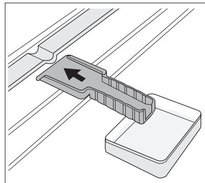
4. Ist das Geräteinnere vollständig abgetaut, trocken Sie die nassen Oberflächen gründlich ab und bewahren Sie den Kunststoffschaber für eine spätere Verwendung auf.
