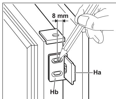
11. Nehmen Sie die Halterungen wieder ab. Markieren Sie 8 mm von der Außenkante der Stelle, an der der Nagel (K) eingeschlagen werden muss.
