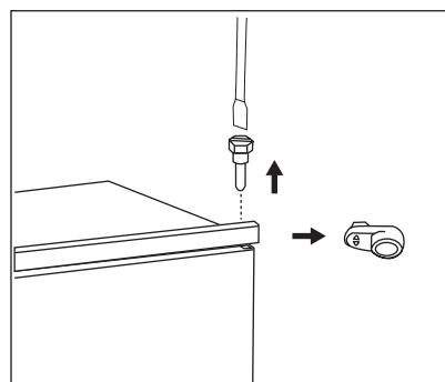
4. À l'aide d'une clé, desserrez la vis inférieure.
