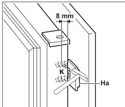
12. Setzen Sie das Führungsstück erneut auf die Führungsschiene und schrauben Sie es mit den mitgelieferten Schrauben fest.
