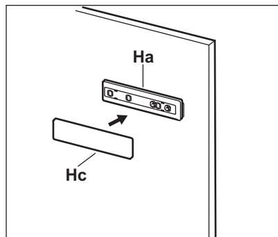
10. Öffnen Sie die Gerätetür und die Tür des Küchenmöbels in einem Winkel von 90°. Setzen Sie das Führungsstück (Hb) in die Führungsschiene (Ha) ein. Bringen Sie die Gerätetür und die Küchenmöbeltür zusammen und markieren Sie die Bohrungen.
