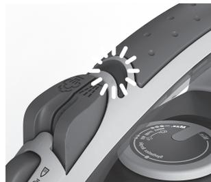
**3. Schließen Sie das Netzkabel an eine Netzsteckdose an.** Die Netzspannungsanzeige leuchtet. Stellen Sie die gewünschte Temperatur durch Drehen des Temperaturwählers ein. Wenn die Anzeige erlischt, ist das Bügeleisen betriebsbereit.
