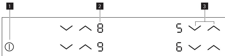
Gebruik de sensorvelden om het apparaat te bedienen. De displays en indicatielampjes geven aan welke functies worden gebruikt.
