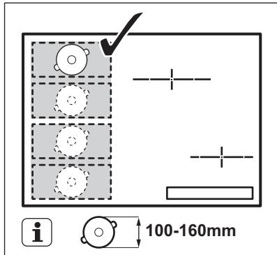
Placez l'ustensile avec un fond de plus de 160 mm de diamètre au centre entre deux sections.
