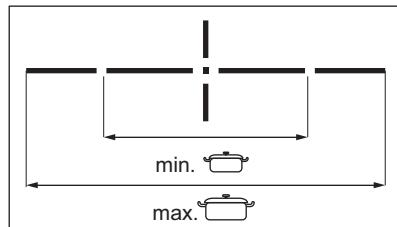
Die waagerechte Linie zeigt die maximale Größe des Kochgeschirrs an. Die Unterbrechung in der horizontalen Linie zeigt den kleinsten Kochgeschirrdurchmesser an.
