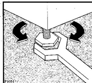
Une mise à niveau correcte évite des vibrations, du bruit ou des déplacements de l'appareil durant son fonctionnement.
