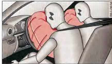
Fig. 121 Airbags frontaux déployés
