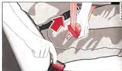
Fig. 118 Libération du pêne du boîtier de verrouillage
