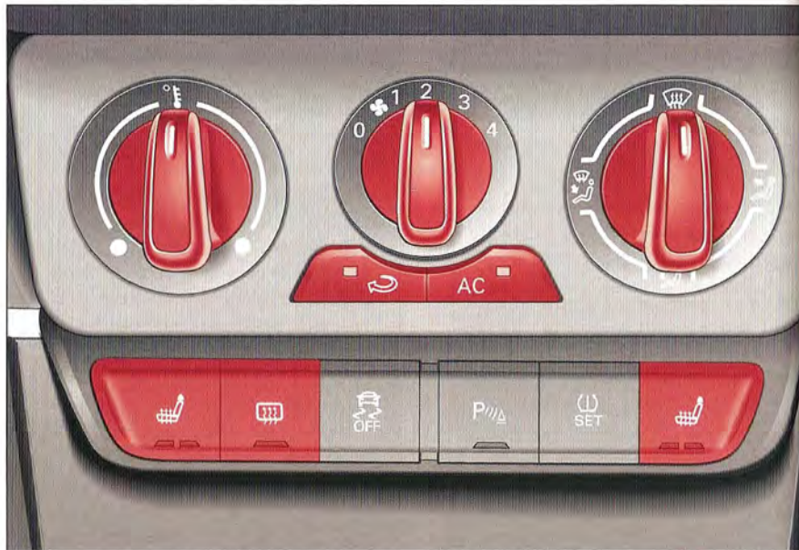
Fig. 76 Commandes du système de chauffage et de ventilation ou du climatiseur manuel*
