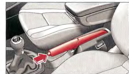
Fig. 82 Vue partielle de la console centrale : frein à main serré
