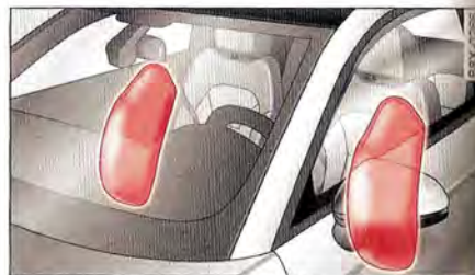
Fig. 124 Airbags latéraux déployés
