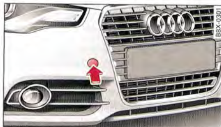
Fig. 179 Pare-chocs avant droit : capuchon de protection
