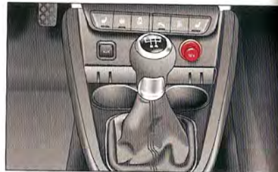
Fig. 62 Console centrale : prise de courant
