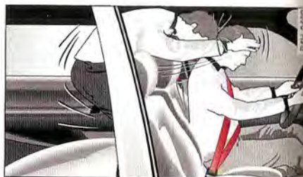
Fig. 112 Le passager arrière non attaché est projeté vers l'avant
