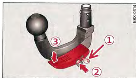
Fig. 139 Dispositif d'attelage amovible : dépose de la boule d'attelage
