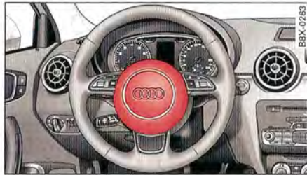
Fig. 119 Airbag conducteur intégré au volant de direction
