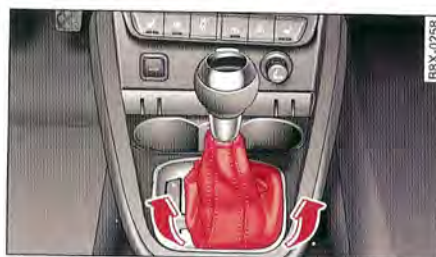
Fig. 98 Levier sélecteur : retrait du cache
