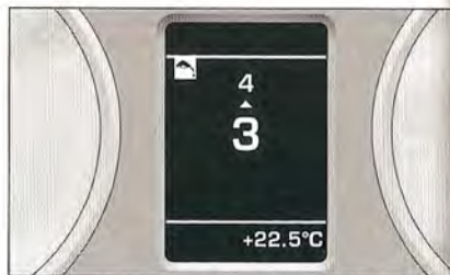
Fig. 22 Écran : indicateur élargi de changement de rapport
