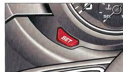
Fig. 4 Combiné d'instruments : touche SET
