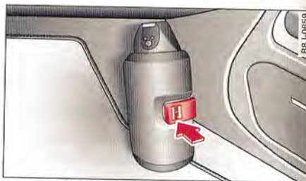
Fig. 163 Extincteur au plancher, côté passager avant
