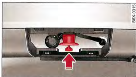
Fig. 140 Zone du pare-chocs arrière : mise en place de l'obturateur
