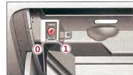
Fig. 127 Boîte à gants : commande à clé permettant de désactiver l'airbag du passager avant
