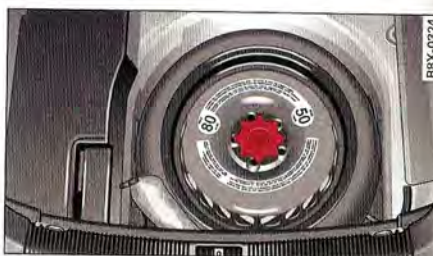
Fig. 166 Roue d'urgence dans le cuvelage de la roue de secours
