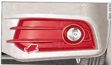
Fig. 202 Partie avant gauche : extraction du cache
