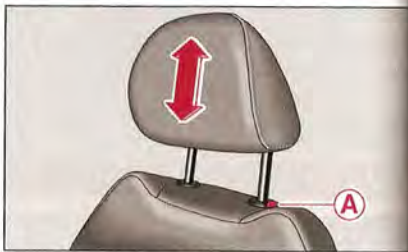
Fig. 58 Siège avant : réglage et dépose/repose de l'appuie-tête
