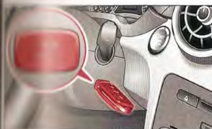
Fig. 81 Colonne de direction/clé à radiocommande : démarrage du moteur en cas de perturbation
