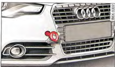
Fig. 180 Pare-chocs avant droit : œillet de remorquage vissé
