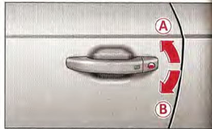
Fig. 30 Porte du conducteur : barillet
