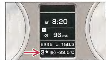
Fig. 20 Écran : indicateur de changement de rapport
