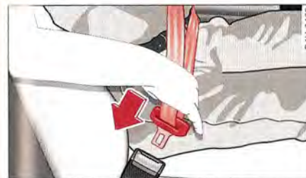
Fig. 114 Siège du conducteur : boîtier de verrouillage et pêne
