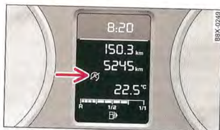
Fig. 88 Combiné d'instruments sans système d'information du conducteur : fonction « arrêt du moteur » momentanément non disponible
