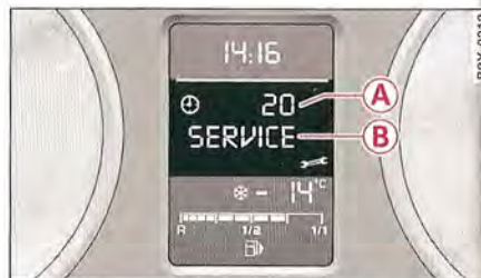
Fig. 10 Écran : exemple d'affichage de l'indicateur de périodicité d'entretien
