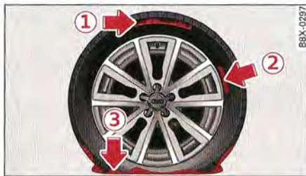
Fig. 175 Dommages pour lesquels le kit anticrevaision ne convient pas
