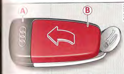
Fig. 28 Clé à radiocommande : retrait du cache
