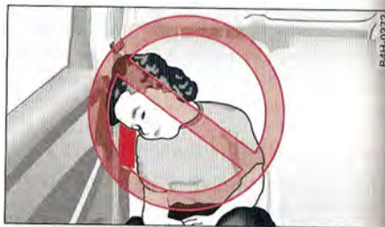
Fig. 102 Représentation schématique d'une position assise dangereuse dans la zone de déploiement de l'airbag latéral.
