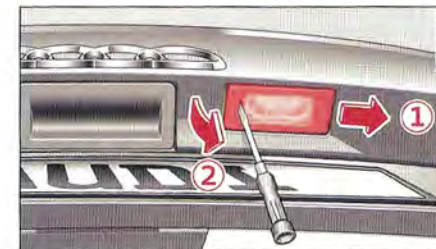
Fig. 212 Hayon : dépose du feu de plaque minéralogique
