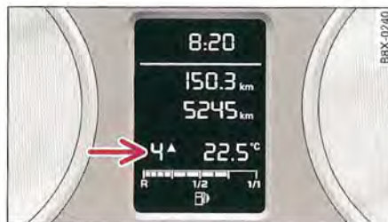
Fig. 9 Écran : indicateur de changement de rapport
