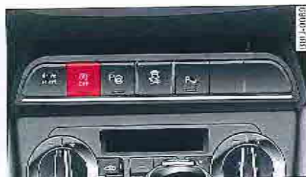
Fig. 88 Console centrale : touche du système start/stop
