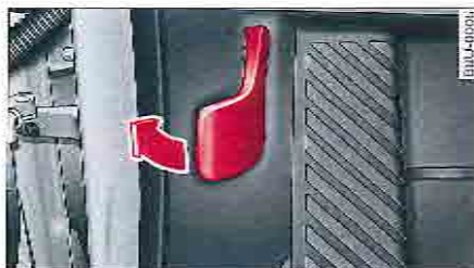
Fig. 164 - Plancher côté conducteur : levier de déverrouillage
