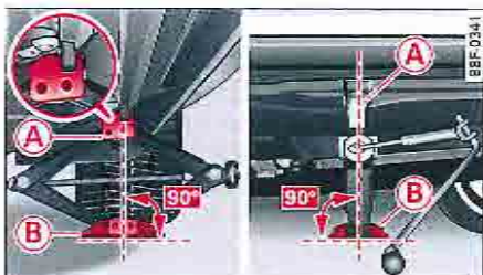
Fig. 190 Bas de caisse : cric se en place du cric
