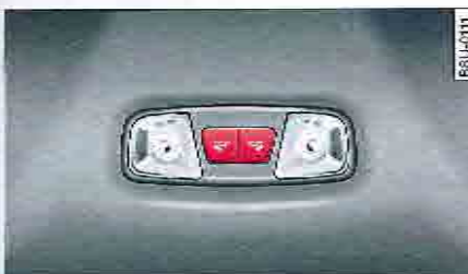
Fig. 45 Partie arrière du ciel de pavillon : commandes des lampes de lecture à LED*
