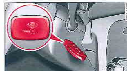
Fig. 83 Colonne de direction/clé à radio commande : lancement du moteur en cas de perturbation
