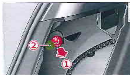
Fig. 157 Coffre à bagages : bouton de déverrouillage du dispositif d'attelage
