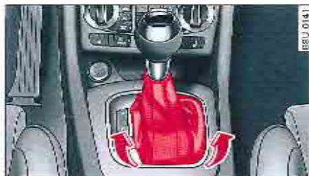
Fig. 94 - Levier sélecteur : retrait du soufflet.
