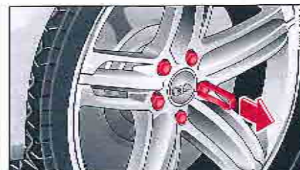
Fig. 187 Changement de roue : retrait des capuchons de protection
