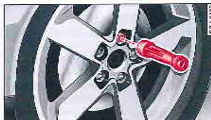
Fig. 191 Chargement de roue : six pans creux pour le serrage des boulons
