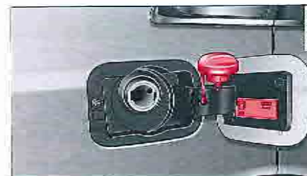
Fig. 162 Volet du réservoir avec bouchon de réservoir
