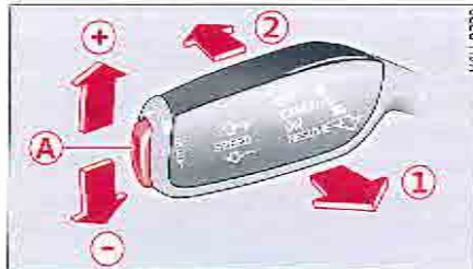
Fig. 89 Levier de commande : régulateur de vitesse
