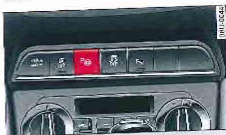
Fig. 120 Console centrale : touche de l'assistant aux manœuvres de stationnement.
