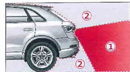
Fig. 112 Zone du champ de vision ① et zone en dehors du champ de vision ② de la caméra de recul.
