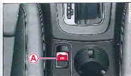
Fig. 84 Console centrale : frein de stationnement
