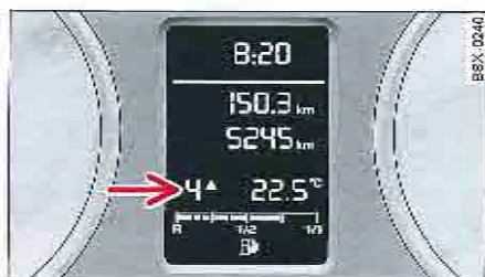
Fig. 12. Combiné d'instruments : indicateur de changement de rapport sur les véhicules sans système d'information du conducteur
