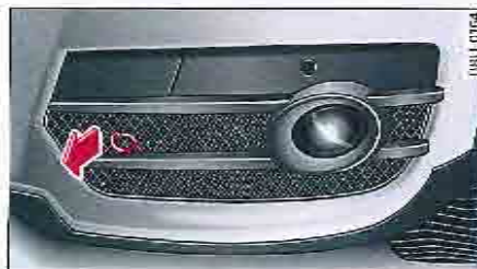
Fig. 216 Phare antibrouillard : retrait du cache.
