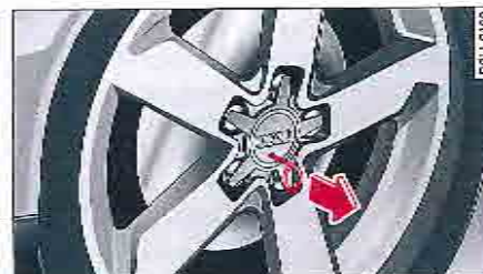
Fig. 186 Changement de roue : retrait du capuchon de roue
