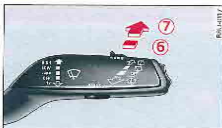
Fig. 51 - Actionnement de l'essuie-glace arrière
