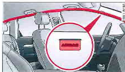
Fig. 151 Emplacement de montage des airbags rideaux au-dessus des portes
