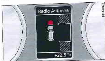
Fig. 122 Combiné d'instruments : place de stationnement détectée, accompagnée de la flèche signalant qu'il faut avancer le véhicule.
