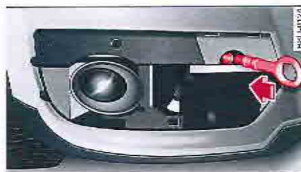
Fig. 196 Avant du véhicule : vissage de l'œillet de remorquage
