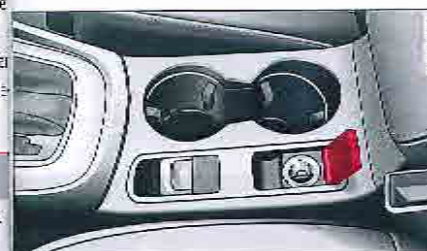
Fig. 63 : Console centrale avant : prise de courant de 12 volts*
