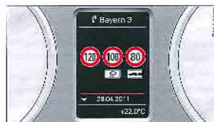
Fig. 21. Combiné d'instruments : exemple d'affichage des limitations de vitesse.
