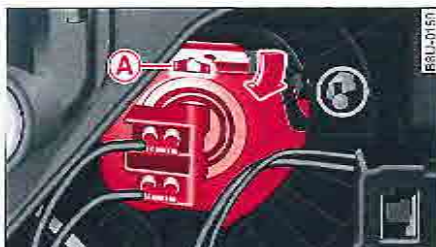
Fig. 210 Connecteur en plastique : repose du feu de croisement
