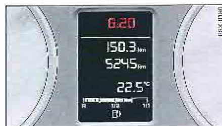
Fig. 9 Combiné d'instruments : réglage de l'heure sur les véhicules sans système d'information du conducteur
