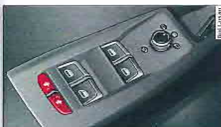
Fig. 36 - Vue partielle de la porte du conducteur : éléments de commande
