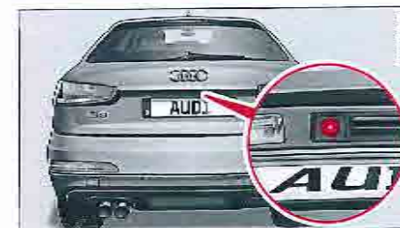
Fig. 113 Rayon ; emplacement de montage de la caméra de recul.
