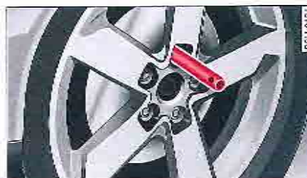
Fig. 192 Changement de roue : axe de montage dans l'orifice supérieur
