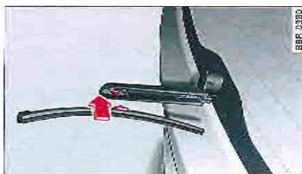
Fig. 53 - Essuie-glace arrière : démontage du balai d'essuie-glace
