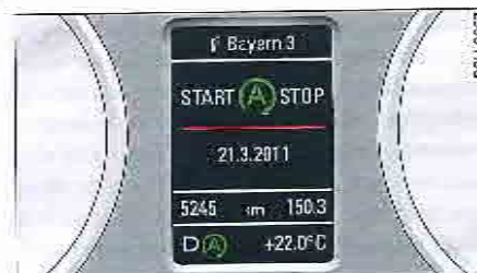
Fig. 86 Combiné d'instruments : moteur coupé (phase stop)
