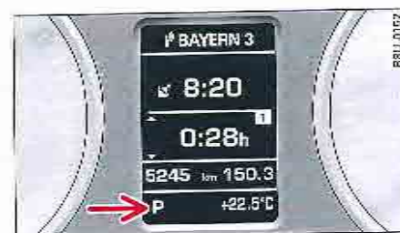
Fig. 90. Combiné d'instruments : positions du levier sélecteur
