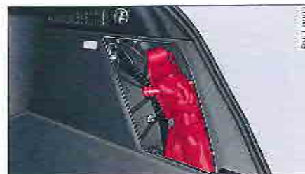
Fig. 179 Coffre à bagages, côté droit : pochette d'outillage de bord et cric
