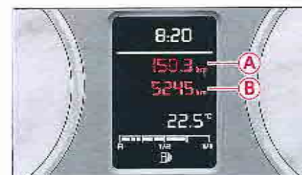
Fig. 11 Combiné d'instruments : compteur kilométrique sur les véhicules sans système d'information du conducteur
