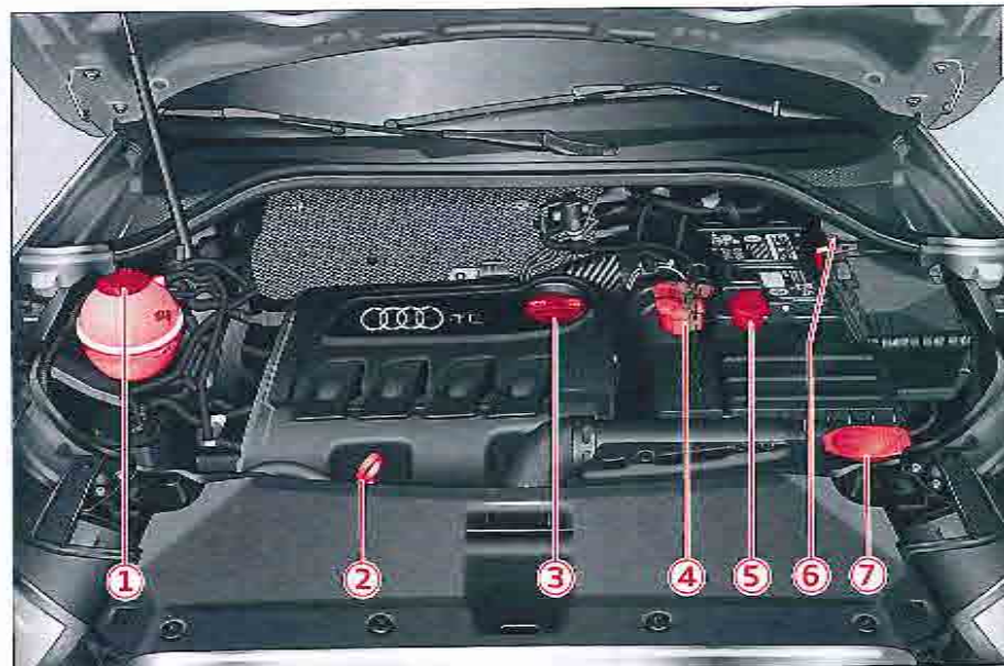
Fig. 166 - Agencement typique des réservoirs et de l'orifice de remplissage d'huile-moteur
