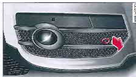
Fig. 195 Avant du véhicule : retrait du cache
