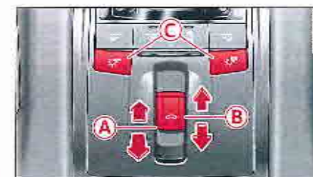
Fig. 38 Vue partielle du ciel de pavillon avant : touche du toit en verre panoramique
