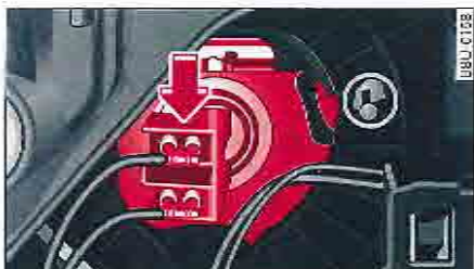
Fig. 209 Connecteur en plastique : dépose du feu de croisement
