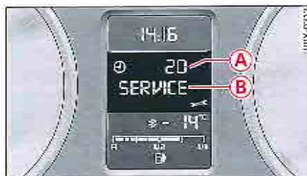
Fig. 14. Combiné d'instruments : indicateur de périodicité d'entretien sur les véhicules sans système d'information du conducteur
