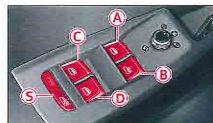
Fig. 37 - Vue partielle de la porte du conducteur : éléments de commande
