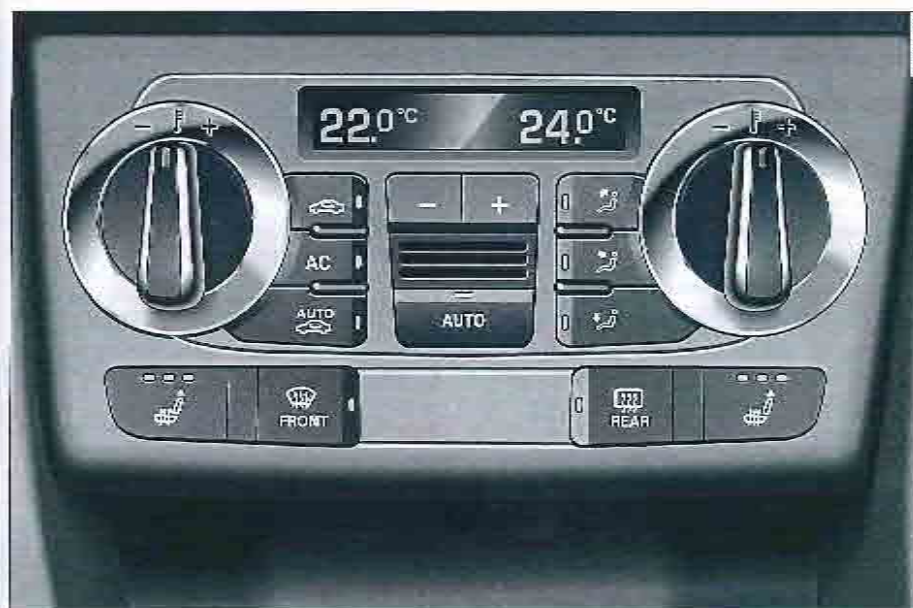
Fig. 79 Commandes du climatiseur automatique confort
