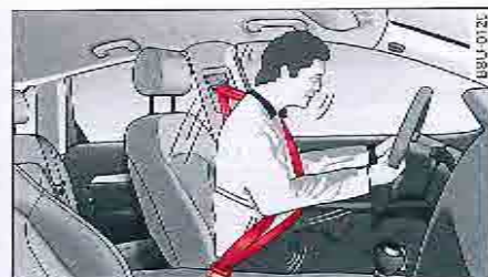
Fig. 134 - Conducteur attaché, retenu en cas de freinage brusque par la ceinture correctement positionnée.
