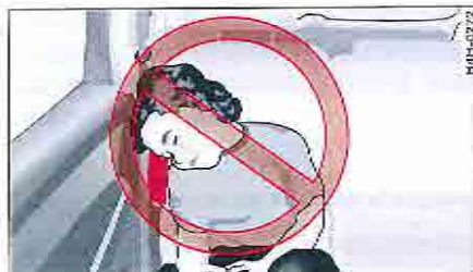
Fig. 127 Représentation schématique d'une position assise dangereuse dans la zone de déploiement de l'airbag latéral.
