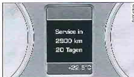
Fig. 15. Combiné d'instruments : indicateur de périodicité d'entretien sur les véhicules avec système d'information du conducteur
