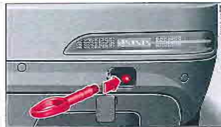
Fig. 198 Pare-chocs arrière : vissage de l'œillet de remorquage
