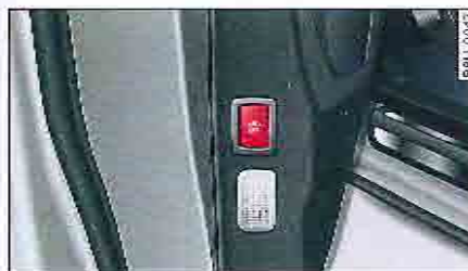
Fig. 32 Face frontale de la porte du conducteur : touche du dispositif de surveillance de l'habitacle et du dispositif anti-remorquage
