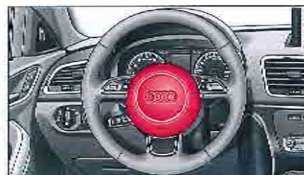
Fig. 145 Airbag conducteur intégré au volant de direction.
