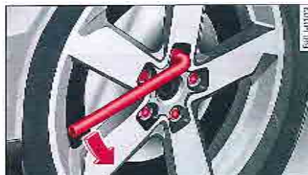
Fig. 188 Changement de roue : desserrage des boulons de roue
