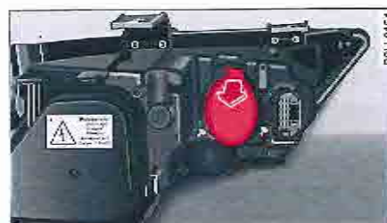
Fig. 205 Phare principal : cache de l'ampoule de feu de route.
