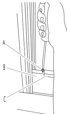
**REMARQUE :** Pour une installation sur le vantail de la fenêtre, le kit de glissière de la fenêtre doit être installé à la verticale avec l'ouverture du kit de glissière de la fenêtre dirigé vers le bas.
