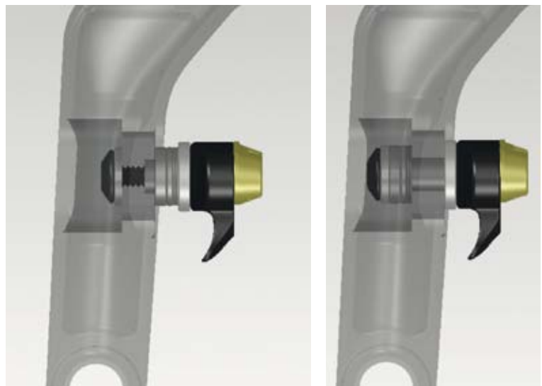
Beispiel: Extrempositionen der Bremsbeläge
