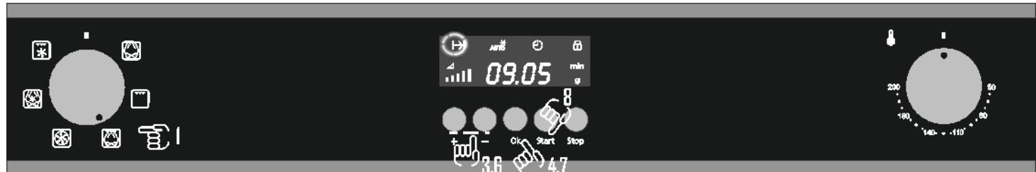
1. Draai de **Functieschakelaar** op de magnetron/grillstand.
