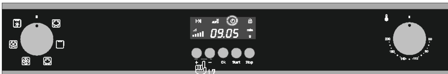
1. Druk tegelijkertijd 3 seconden lang op de “+”- en “-“-toetsen. De punten die het uur van de minuten scheiden, zullen knipperen, maar de rest van de klokaanduiding is verborgen.
