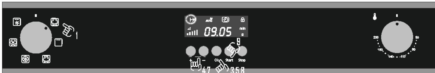
1. Draai de **Functieschakelaar** op de magnetronstand.
