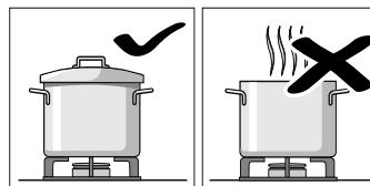
Kook niet zonder deksel of met verschoven deksel. Een deel van de energie gaat verloren.
