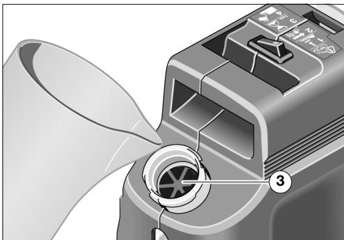
Ao encher, observe que a grelha sobre a proteção de borracha contra respingos 3 não seja premida por objectos de abastecimento.
