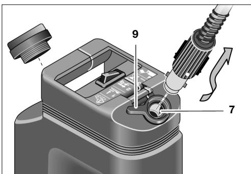
Γι' αυτό περιστρέψτε προς τα επάνω, και με κατεύθυνση ίδια μ' εκείνη των δεικτών του ρολογιού, τη μανδάλωση ασφάλειας **9** στη σύνδεση σωλήνα **7** και αφαιρέστε το στυλιδωτό σύνδεσμο περιστρέφοντάς τον με κατεύθυνση αντίθετη εκείνης των δεικτών του ρολογιού.
