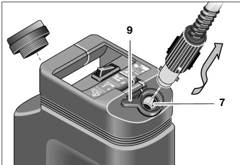
Dazu am Schlauchanschluss **7** die Sicherheitssperre **9** im Uhrzeigersinn nach oben drehen und den Bajonettverschluss gegen den Uhrzeigersinn drehend abziehen.
