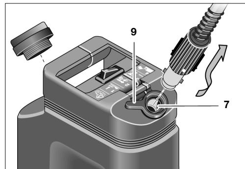
Drej sikkerhedsspærren **9** på tilslutningen **7** opad i urets retning og fjern bajonetlåsen ved at dreje den imod uret.
