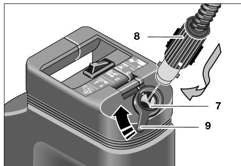
Girar el bloqueador de seguridad **9** hacia arriba en el sentido de las agujas del reloj.
