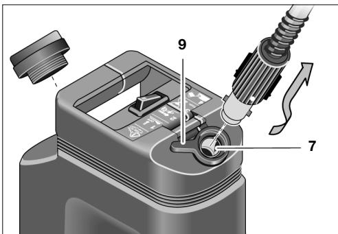
Tee tämä kiertämällä letkuliittimen **7** varmuuslukko **9** myötäpäivään ylöspäin ja irrottamalla pikaliitin kiertämällä sitä vastapäivään samalla vetää.
