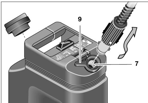
A tal fine, ruotare verso l'alto in senso orario il blocco di sicurezza **9** al raccordo per tubo **7** ed estrarre l'innesto a baionetta ruotandolo in senso antiorario.
