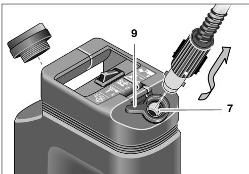
Daarvoor op de slangaansluiting **7** de veiligheidsblokering **9** met de wijzers van de klok naar boven draaien en bajonetssluiting tegen de wijzers van de klok draaiend lostrekken.
