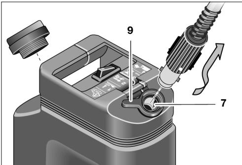
Para ello, girar hacia arriba el bloqueador de seguridad **9** en el racor de manguera **7** en el sentido de las agujas del reloj y extraer el cierre de bayoneta girándolo en sentido contrario a las agujas del reloj.
