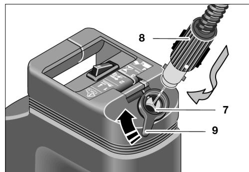
Ruotare verso l'alto in senso orario il blocco di sicurezza 9.
