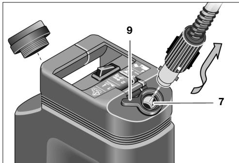
Pour ce faire, tourner le clapet de sécurité **9** dans le sens des aiguilles d'une montre (vers le haut) puis dévisser le dispositif de fermeture à baïonnette (rotation dans le sens inverse des aiguilles d'une montre).
