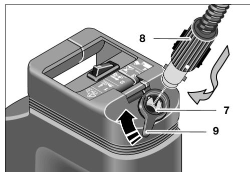
Die Sicherheitssperre **9** im Uhrzeigersinn nach oben drehen.
