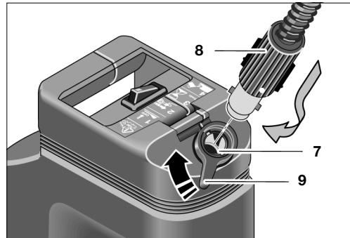
Drej sikkerhedsspærren **9** opad i urets retning. Stik bajonetlåsen **8** på slangen ind i tilslutningen **7** og drej den ind i urets retning.
