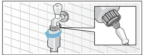
6. Nettoyage du filtre à l'arrière de l'appareil sur les modèles Standard et Aqua-Secure : Retirer le flexible au dos de l'appareil, Extraire le filtre avec une pince et le nettoyer.
