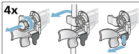
3. Mettre les couvercles en place. Verrouiller fermement les couvercles en appuyant sur le crochet de crantage.
