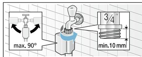
**Remarque :** Ouvrir prudemment le robinet d'eau tout en vérifiant si les raccords sont étanches. La jonction par vis se trouve sous la pression régnant dans la conduite d'eau.
