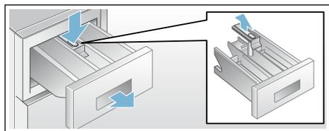
3. Avec de l'eau et une brosse, nettoyez le bac d'introduction du produit et l'insert, puis séchez-les. Nettoyez le boîtier aussi à l'intérieur.
