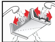
6. Enlevez les peluches des joints du sèche-linge et de l'échangeur thermique.
