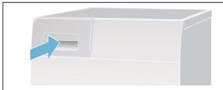
**Remarque :** Le filtre du réservoir d'eau de condensation filtre l'eau de condensation utilisée pour le nettoyage automatique de votre sèche-linge. Le filtre est nettoyé en vidant l'eau de condensation. Vérifiez régulièrement que le filtre ne contient pas de dépôt et retirez-les le cas échéant. Voir → Page 38.
