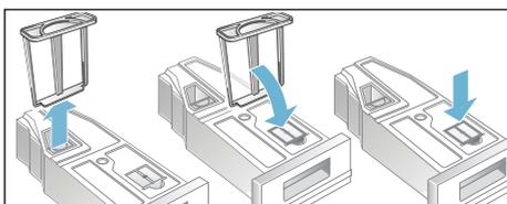
9. Poussez le réservoir d'eau de condensation jusqu'à ce qu'il se bloque.
