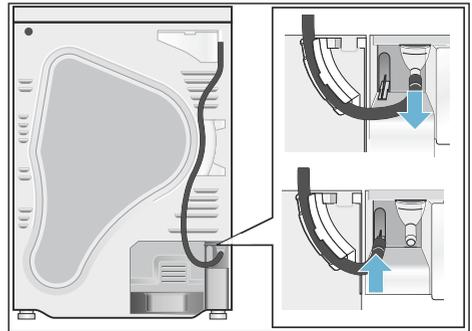
4. Enlevez le flexible d'écoulement des accessoires et fixez-le sur le manchon libre.
