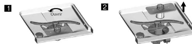
étape 1 : faire tourner le Filtre dégrossisseur dans le sens des aiguilles d'une montre, puis le soulever;
