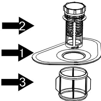
Le système de filtrage se compose d'un filtre cylindrique (Filtre à maille large), d'un filtre plat (Filtre principal) et d'un microfiltre (Filtre à maille fine).
