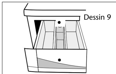
Le bac "LAVAGE" peut contenir les poudres et les liquides, toutefois, ne pas utiliser de lessive liquide pour les programmes AVEC prélavage et/ou AVEC "départ différé" (suivant modèle).
