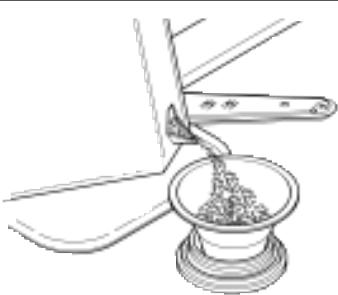
De afwasmachine is uitgerust met een automatische waterverzachter die de harde bestanddelen aan het water onttrekt.
