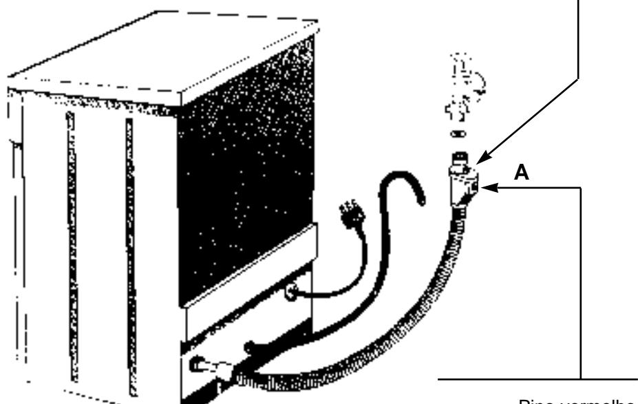
Pino vermelho à vista (no visor): válvula de bloqueio da passagem da água activada.
