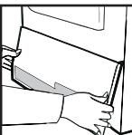
2.Oba vzvoda, ki zadržujejo kondenzator, obrnrite v nasprotni smeri urnega kazalca in izvlecite kondenzator.
