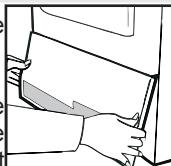
2. Tournez les deux leviers de blocage dans le sens contraire des aiguilles d'une montre et retirez le condenseur.
