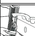
6.Kondenzator ponovno namestite, pri tem pa pazite, da je pravilno obrnjen (kot kaže puščica) ter da ga trdno potisnete na njegovo mesto. Oba vzvoda ponovno zaprite tako, da ju obrnete v smeri urnega kazalca. Z obračanjem v desno zapahnite oberočici. Prepričajte se, da je kondenzator trdnov podnožju.
