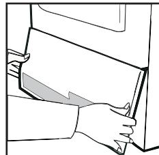
2. Tirez fermement sur la poignée et faites glisser le réservoir d'eau en dehors du sèche-linge. Tenez-le fermement à deux mains. Lorsque le bac est plein, il pèse environ 4 kg.
