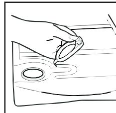
5. Remettez la plaque de protection en place en engageant les charnières du haut et en enclenchant les attaches inférieures en place.
