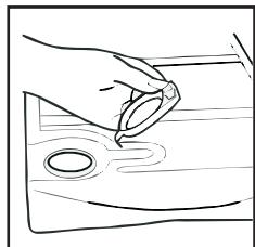
5. Vuelva a instalar el protector acoplando los goznes de la parte superior y haciendo que los ganchos de abajo entren en posición de un golpe seco.
