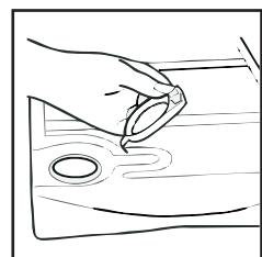
**5.** Aseta jalkalista takaisin kiinnittämällä yläosan koukut ja 'napsauttamalla' listan alaosaa sitten paikoilleen.
