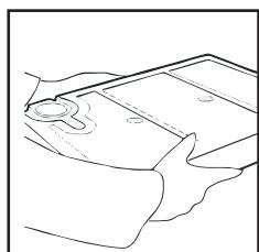
4. Vuelva a poner la tapa de nuevo y reinstale el recipiente para agua, deslizándolo hasta que entre en su posición. PRESIONE LO FIRME HASTA QUE ENTRE EN SU POSICIÓN.
