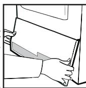
2.Drei de to låsespakene mot urviserne og trekk ut kondensatoren.
