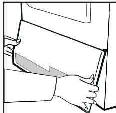
2. Tirez fermement sur la poignée et faites glisser le réservoir d'eau en dehors du sèche-linge.
