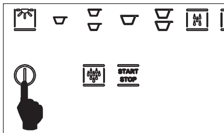
Fig. 7.10 Pour quitter la modalité Stand-by, enfoncer la touche on/off d'après la fig. 8.10, le voyant commence à clignoter jusqu'à ce que la machine soit en état de « prête » ; à présent, tous les voyants, relatifs aux différents services, s'allument.
