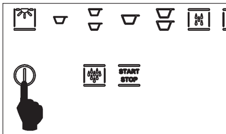
Fig. 7.10 Per uscire dalla modalità Stand-by si deve premere il tasto on/off come indicato in fig. 8.10, il led inizierà a lampeggiare fino al raggiungimento dello stato di macchina "pronta", a questo punto tutti i led, relativi ai vari servizi, si illuminano.
