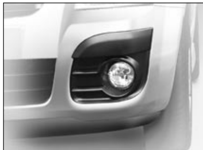
Projecteurs antibrouillard Consultez le réseau CITROËN. Lampe : H1
