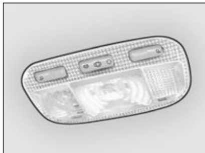
Plafonnier Déclipez le couvercle du plafonnier pour accéder à la lampe. Lampe : W 5 W Spots de lecture Déclipez le couvercle du plafonnier pour accéder à la lampe. Lampe : W 5 W
