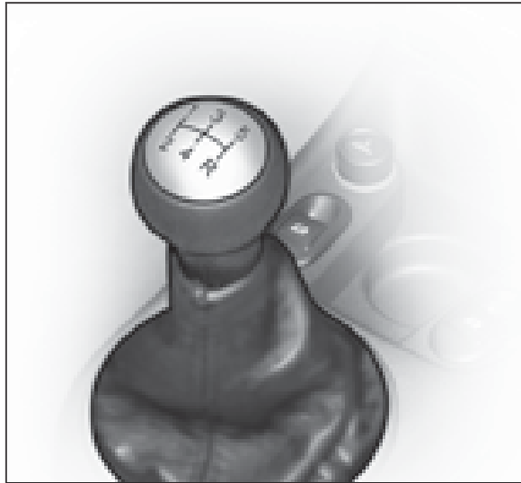
Levier de vitesses de la boîte manuelle.
