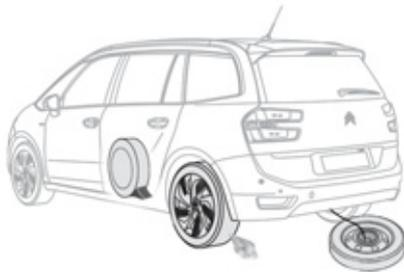
La roue de secours est maintenue par un système de treuil sous le véhicule.
