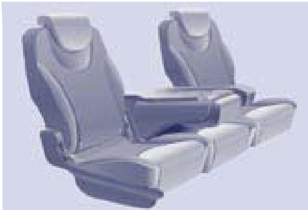
Type 3 : une assise deux places avec dossiers individuels inclinables, repliables en position tablette et assise relevable.
