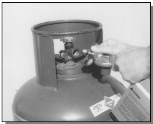
Regulador con orificio de ventilación hacia abajo
