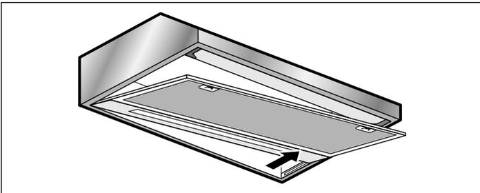
4. Drähte entfernen und Vlies-Fettfilter entnehmen.
