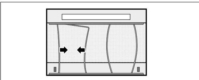
5. Nettoyer l'appareil à l'intérieur après avoir démonté le filtre à graisse en intissé.
