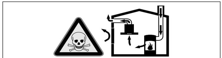
Vuurbronnen die de lucht in de ruimte verbruiken (bijv. apparaten die op gas, olie, hout of kolen worden gestookt, geisers, warmwatertoestellen) trekken de verbrandingslucht uit de opstellingsruimte en voeren de gassen via een afvoer (bijv. schoorsteen) af naar buiten.
