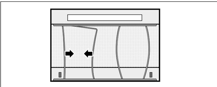
5. Nach der Demontage des Vlies-Fettfilters das Gerät von innen reinigen.
