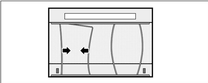
5. Na demontage van de vlies-vetfilter het apparaat van binnen schoonmaken.
