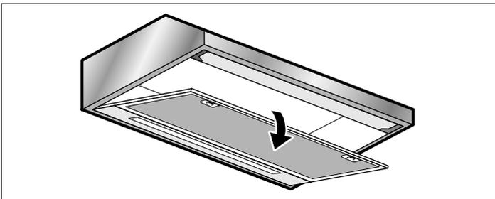
3. Filtergitter schräg positionieren und abnehmen.
