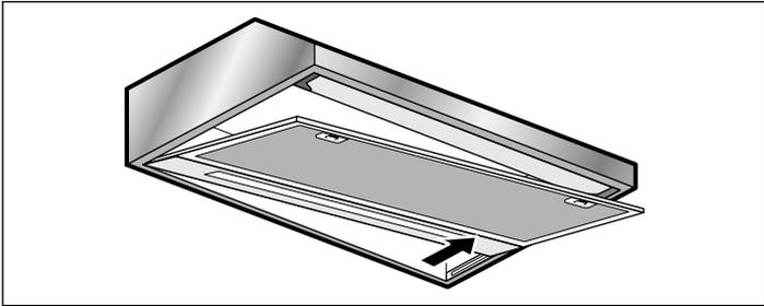
4. Draden verwijderen en vlies-vetfilter verwijderen.
