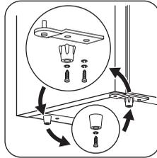
5. Enlevez la vis fixant la charnière inférieure à la porte et l'autre vis fixant la charnière inférieure de la porte et le pied comme le montre l'illustration.
