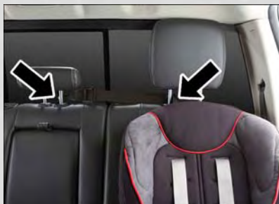
Courroie d'attache par la boucle de courroie d'attache du siège d'extrémité et fixé à la boucle de courroie d'attache du siège central
