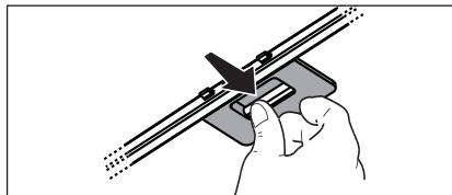
**Type 15 - NEM Mosható aktív szénfilter.** A szénfilter telítődése többé vagy kevésbé hosszú idő alatt történik meg, a tűzhely típusától és a zsírszűrő tisztagatásának rendszerességtől függően. mindenkorban cserélni kell a betétet legalább négy havonként.
