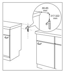
2. L'orifice se trouve sur le côté gauche, à l'arrière de l'appareil. Soulevez l'avant de l'appareil et placez-le au milieu de l'espace entre les placards. Si l'espace entre les placards est supérieur à la largeur de l'appareil, vous devez ajuster la mesure latérale si vous souhaitez centrer l'appareil.
