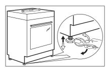
Utilisez les petits pieds situés sous l'appareil pour mettre la surface supérieure de l'appareil de niveau avec les autres surfaces environnantes.
