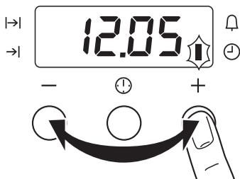
Lorsque vous branchez l'appareil ou en cas de coupure de courant, le voyant de la fonction de l'horloge clignote automatiquement.
