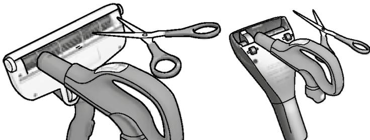
**1. Pulizia della bocchetta Turbo.** (solo per alcuni modelli) Staccare la bocchetta dal tubo dell'aspirapolvere e rimuovere le fibre e gli altri oggetti impigliati tagliandoli con le forbici. Per pulire la bocchetta, utilizzare l'impugnatura del flessibile. \*
