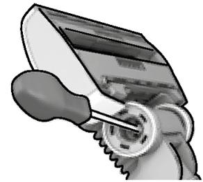
3. Desatornille el eje de la rueda y limpie todas las piezas. Realice el montaje en orden inverso.
