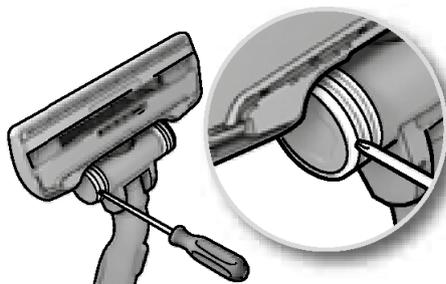
2. **Se le ruote sono bloccate**, pulirle rimuovendo i copriruota con l'ausilio di un piccolo cacciavite.
