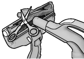
2. Extraiga el cepillo de rodillo y retire los hilos enganchados; para ello, córtelos con unas tijeras. Utilice el asa del tubo flexible para limpiar la boquilla. Realice el montaje en orden inverso.
