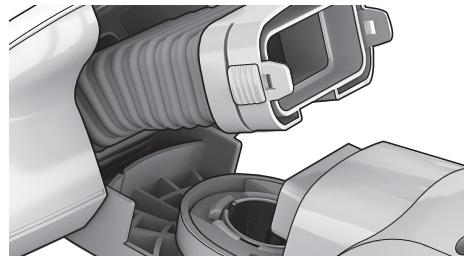
**1. Atlaisvinkite fiksatorių ir iš įtaiso ištraukite žarną.** Pašalinkite bet kokias atliekas. Įdėkite žarną atgal į įtaisą ir užfiksujokite ją fiksatoriumi.
