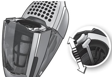
**3. Peenfiltri kiire puastamine.** (Soovitatav igal puastamisel). Vabastage tolumahuti ning tömmake ja vabastage tolmu eemaldamiseks vedru 5–6 korda.
