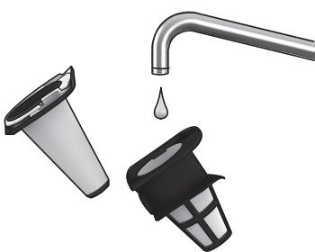
4b. Ločite filtre. Zbiralnik za prah in filtra lahko otresete ali pa jih splaknete s toplo vodo (*nikoli jih ne perite v pomivalnem stroju*). Preden dele znova namestite in nasprotinem vrstnem redu, jih dobro osušite.
