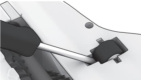
**2. Если колеса нужно очистить, осторожно снимите их небольшой отверткой.**
