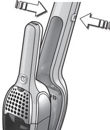
1. Rimuovere l'unità manuale premendo entrambi i pulsanti di rilascio. La bocchetta per fessure e lo spazzolino vengono riposti nel caricabatterie.
