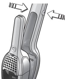
1. Откачете ръчния модул с натискане на бутоните за освобождаване. Накрайникът за тесни места и малката четка стоят в зарядната поставка.
