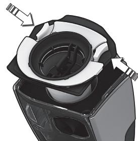
**4a. Rengjøring av støvbeholder og filtre.** (Anbefales for hver femte rengjøring.) Løsne støvbeholderen og ta ut begge filtrene ved å trykke på frigjøringsknappene.
