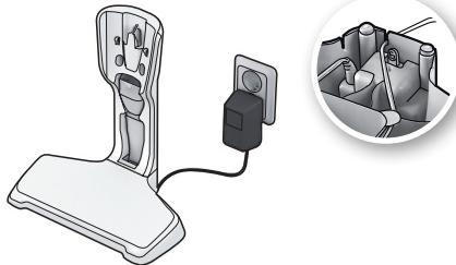
1. Polnilno enoto postavite daleč stran od topotnih virov, neposredne sončne svetlobe ali mokrih površin. Priključite električni napajalnik v vtičnico in ga povežite s polnilno enoto.
