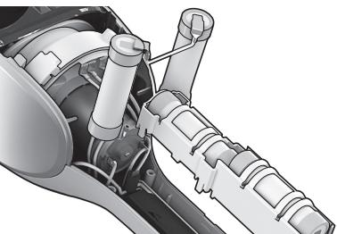
2. **Odstranite priključne kable,** odstranite bateriju in z lepilnim trakom oblepite vidne kovinske dele. Baterije odložite v ustrezno embalažo.
