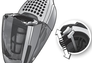
**3. Быстрая очистка тонкого фильтра.** (Рекомендуется при каждой чистке.) Снимите пылесборник и сожмите пружину 5–6 раз, чтобы выбить пыль.
