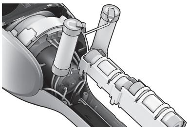
2. **Verbindungskabel trennen**, Akkus herausnehmen, sichtbare Metallbereiche mit Band abkleben. Akkus in geeigneten Behältern verpacken.
