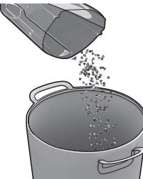
**2. Tolumahuti tühjendamine.** Eemaldage filtrid ning tühjendage sisu prügikasti. Paigaldage filtrid ning klöpsake tolumahuti oma kohale.
