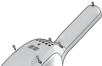
1. Batteriene skal alltid tömmes før de tas ut. **Ergorapido må kobles fra ladestasjonen når batteriene tas ut.** Løsne skruene. Løft dekselet forsiktig.
