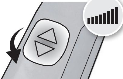
3. Nastavite stopnjo moči s pritiskom spodnjega dela tipke za vklop/izklop.
