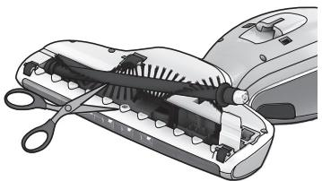
**2. Извлеките щетку-ролик и очистите ее.** Удалите нити острым предметом. Установите ролик на место и убедитесь, что он свободно вращается. Закройте крышку.
