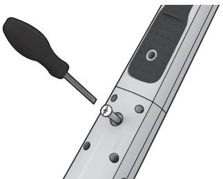
**2. Fissare l'impugnatura** serrando la vite di bloccaggio in dotazione con un cacciavite o una moneta.
