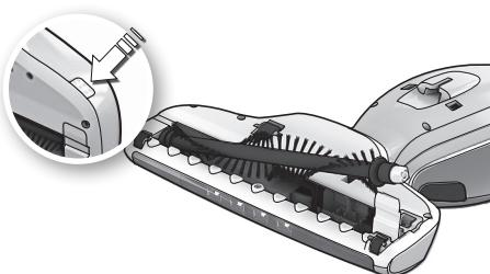
1. Najprej izklopite sesalnik. Pritisnite gumb za sprostitev krtačnega valja. Pokrov se rahlo odpre, da lahko odstranite krtačni valj.
