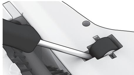
2. **Hvis hjulene trenger rengjøring,** tar du dem forsiktig av med en liten skrutrekker.
