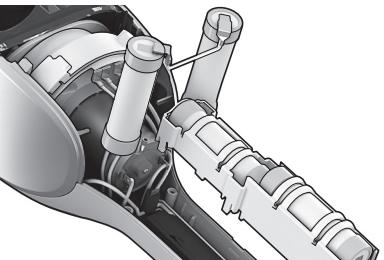
2. **Kutt tilkoblingsledningene**, ta ut batteriene og sett teip over de synlige metalområdene. Legg batteriene i en hensiktsmessig emballasje.
