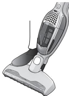
1. Kontroller at støvsuger-en er slått på og at den står på et hardt og jevnt underlag. Ikke bruk funksjonen BRUSHROLLCLEAN™ TECHNOLOGY på tykk teppe eller matter med lange hår.
