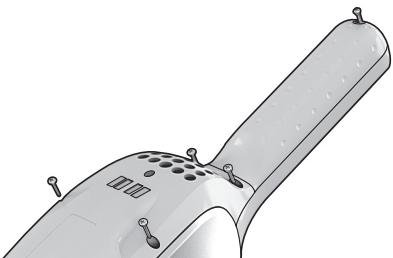
1. Batterien sollten vor dem Herausnehmen immer entladen werden. **Ergorapido muss zum Herausnehmen der Akkus von der Ladestation getrennt werden.** Schrauben lösen. Oberes Gehäuseteil vorsichtig abnehmen.
