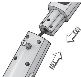
**1. Controllare che nella confezione siano presenti tutti i componenti.** Montare l'impugnatura inserendola con cura nella parte inferiore del corpo principale. Assicurarsi che il cavo non si inceppi.
