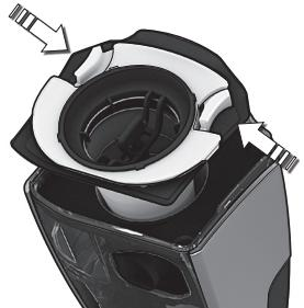
**4a. Очистка пылесборника и фильтров.** (Рекомендуется при каждой 5-й чистке.) Снимите пылесборник и выньте оба фильтра, нажав на кнопки-фиксаторы.
