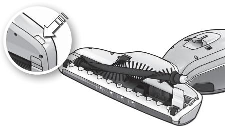
**1. Выключите пылесос Ergorapido.** Нажмите кнопку фиксатора щетки-ролика. Крышка немного ослабнет, и щетку-ролик можно будет вынуть.
