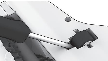
2. Če je potrebno očistiti kolesca, ju z majhnim izvijačem previdno odstranite.
