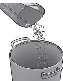
**2. Опорожнение пылесборника.** Выньте фильтры и вытряхните содержимое в мусорное ведро. Установите фильтры и защелкните пылесборник на место.
