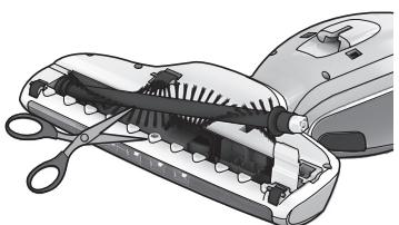
2. Krtačni valj vzemite ven in ga očistite. Niti odrezite z ostrim predmetom. Valj ponovno vstavite in preverite, ali se vrte. Zaprite pokrov.
