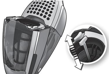
3. Hitro čiščenje filtra za drobne delce (priporočljivo ob vsakem čiščenju). Odstranite zbiralnik za prah, pet- ali šestkrat povlecite in spustite vzem, da odstranite prah.
