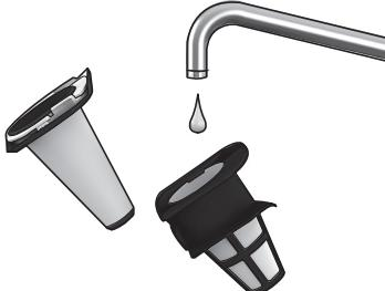
**4b. Отделите фильтры.** Пылесборник и фильтры для очистки можно потрясти или промыть теплой водой (**ни в коем случае не в посудомоечной машине**). Перед тем как поместить на место, все детали следует просушить.
