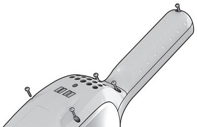
1. Prima di rimuovere le batterie, farle esaurire completamente. **Scollegare l'aspirapolvere Ergorapido dal caricabatterie prima di procedere alla rimozione delle batterie.** Allentare le viti. Sollevare con cautela la copertura.
