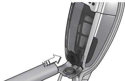
**1. Hurtigtømming av støvbeholderen.** Åpne støvsugerdekselet. Tøm støvbeholderen ved å sette slangen til en vanlig støvsuger foran åpningen.
