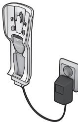
3. **Също така можете да монтирате на стената модула за монтаж на стена.** Отделете модула за монтаж на стена от модула за под. Винаги проверявайте дали стената може да издържи на тежестта на Ergorapido.
