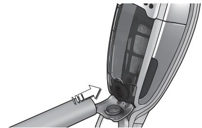
1. Hitro praznjenje zbiralnika za prah. Odprite pokrov sesalnika. Očistite zbiralnik za prah, tako da od optiptino vstavite cev drugega sesalnika in prah posesate.
