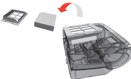
Reinig het schuimfilter elke 3 tot 4 maanden of wanneer het zichtbaar vervuild is. Laat het filter 6 tot 12 uur drogen voor u het terugplaast.
