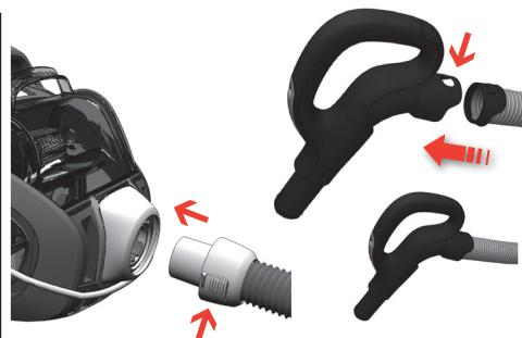
**Inserire il tubo flessibile** (per rimuoverlo, premere i pulsanti di rilascio ed estrarre il tubo).
