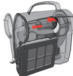
Irrota kartionmallinen muovisuodatin vetämällä se irti.
