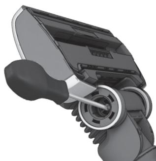
Desatornille el eje de la rueda y limpíe todas las piezas. Realice el montaje en orden inverso.
