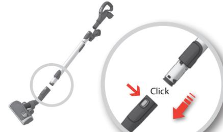
**Collegare il tubo telescopico alla bocchetta per pavimenti** (per rimuoverlo, premere il pulsante di rilascio ed estrarre il tubo).
