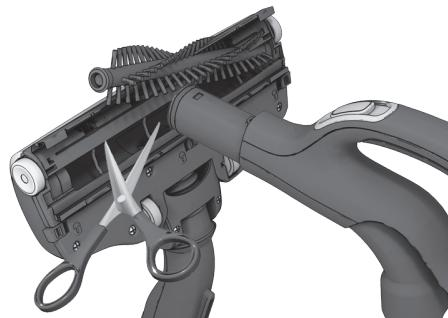
Τραβήξτε προς τα έξω τη βούρτσα-ρολό και αφαιρέστε τυχόν μπλεγμένες κλωστές κόβοντάς τις με φαλίδι. Χρησιμοποιήστε τη χειρολαβή του εύκαμπτου σωλήνα, για να καθαρίσετε το ακροφύσιο. Τοποθετήστε τα ξανά ακολουθώντας τη διαδικασία αντίστροφα.
