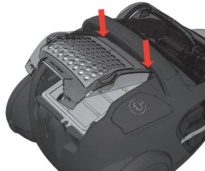
Schuif de haken aan de voorkant van het deksel in de geleiderails om het deksel te sluiten.
