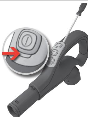
**Sostituire la batteria quando** la spia non si accende alla pressione di alcun pulsante.
