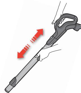
**Säädä teleskooppiputkea** pitämällä lukosta kiinni ja vetämällä kädensijasta toisella kädellä.
