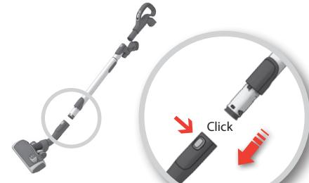
**Bevestig de telescoopbus aan het mondstuk** (om deze weer te verwijderen, drukt u op de ontgrendelknop en trekt u het mondstuk los).
