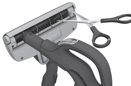
Αποσυνδέστε το ακροφύσιο από το σωλήνα της ηλεκτρικής σκούπας και αφαιρέστε τις μπλεγμένες κλώστες κ.λπ. κόβοντάς τις με ψαλίδι. Χρησιμοποιήστε τη χειρολαβή της εύκαμπτου σωλήνα, για να καθαρίσετε το ακροφύσιο.
