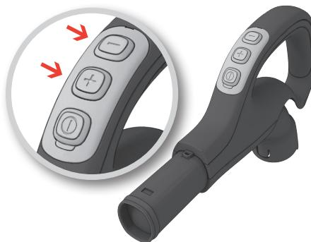
**Отрегулируйте мощность всасывания. (Модели с дистанционным управлением.)**
