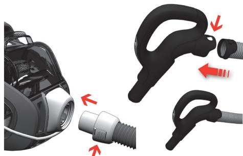
**Bevestig de slang** (om deze weer te verwijderen, drukt u op de ontgrendelknoppen en trekt u de slang los). Schuif de slang in de slanggreep totdat deze in de vergrendelingen klikt (druk op de vergrendelingen om de slang los te maken).
