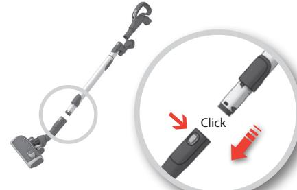
**Kiinnitä teleskooppiputki lattiasuulakkeeseen** (irrota se painamalla vapautuspainiketta ja vetämällä suulake irti).
