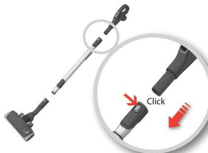
**Acople el tubo telescópico al asa del tubo** (para retirarlo, pulse el botón de bloqueo y tire del asa hacia afuera).
