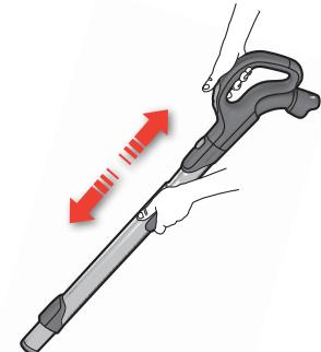
**Regolare il tubo telescopico** tenendo il pulsante di bloccaggio con una mano e tirando l'impugnatura con l'altra.
