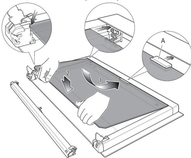
Remplacez le support inférieur en suivant les indications ci-dessous :
