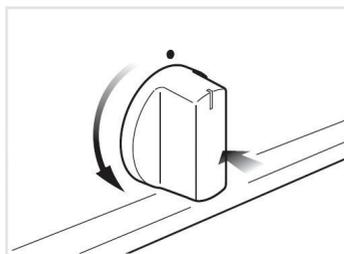
3) Dès que le brûleur s'est allumé, maintenez la manette enfoncée 10 secondes afin de laisser le temps à la flamme de chauffer le thermocouple.
