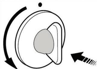
3) Dès que le brûleur s'est allumé, maintenez la manette enfoncée 10 secondes afin de laisser le temps à la flamme de chauffer le thermocouple.
