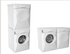
Le sèche-linge est prévu pour la pose libre, mais il peut aussi être placé au-dessus d'une machine à laver de dimensions identiques ou supérieures - largeur 517 mm, profondeur 476 mm (les pieds à ventouses fournis l'empêcheront de glisser de l'appareil). La surface sur laquelle vous le placez doit être propre et plane; la machine à laver doit avoir un couvercle en bois ou en métal. Vous pouvez acheter une plaque décorative pour dissimuler l'espace entre les deux appareils.
