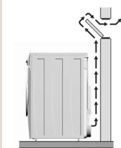
La grille d'aération en façade ou à l'arrière du sèche-linge doivent rester dégagées.
