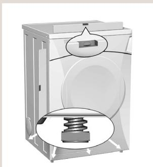
Mettez l'appareil à niveau dans le sens longitudinal et transversal en faisant tourner les pieds réglables qui permettent un ajustement en hauteur de +/- 1 cm.
