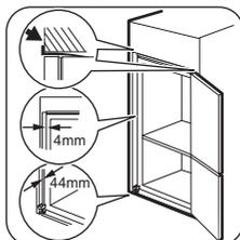
Le cache de la charnière inférieure (dans le sachet d'accessoires) vous permet de vérifier que la distance entre l'appareil et le meuble de cuisine est correcte.
