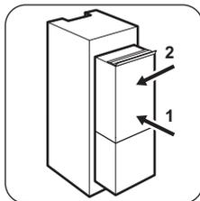
4. Assurez-vous que la distance entre l'appareil et le bord avant du meuble est de 44 mm.
