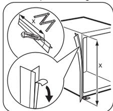
2. Poussez l'appareil dans la direction indiquée par les flèches (1) jusqu'à ce que la partie couvrant l'interstice en haut de l'appareil bute contre le meuble de cuisine.
