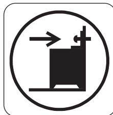
1. Installez la protection anti-bascule à une distance de 317 mm à 322 mm en-dessous de la surface
