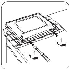
**4** Placez la porte sur une surface stable protégée par un chiffon doux. Utilisez un tournevis pour démonter les 2 vis du bord inférieur du four.
