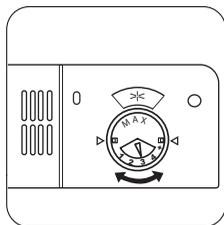
Pour régler la quantité de liquide de rinçage libérée, tournez le sélecteur entre la position 1 (quantité minimale) et la position 4 (quantité maximale).
