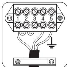
Si la tension de l'habitation est différente, procédez au branchement comme illustré dans le tableau schématique des connexions qui se trouve sur la protection inférieure.
